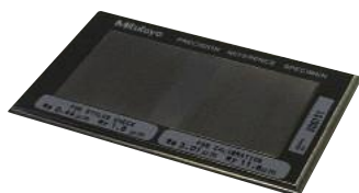
顯示：Ra = 約3 \mu\text{m} 、約0.4 \mu\text{m} No.178-604 ※Ra = 約0.4 \mu\text{m} 者僅可用於測針前端檢查。
